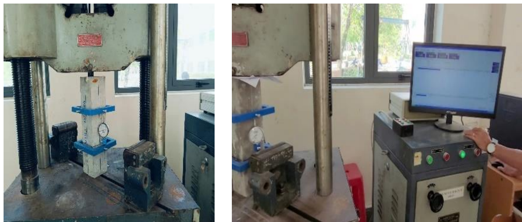
Hình 3.17. Quá trình thực hiện thực nghiệm mô đun đàn hồi
