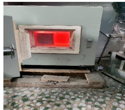
Hình 3.18. a) Nhiệt độ quy định của lò nung theo hàm thời gian theo tiêu chuẩn ISO (ISO 834-1, 1999) và b) Hình ảnh của lò nung
