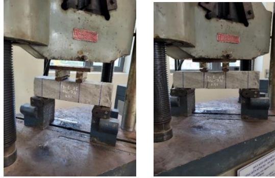
Hình 3.16. Thí nghiệm uốn 4 điểm
