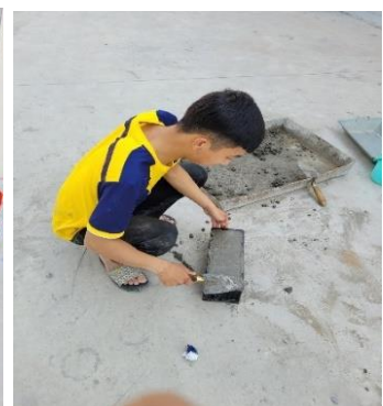
Cho bê tông vào khuôn
