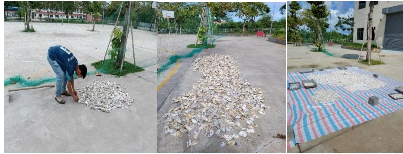
Hình 3.3. Sấy vỏ hào trực tiếp bằng ánh nắng mặt trời
