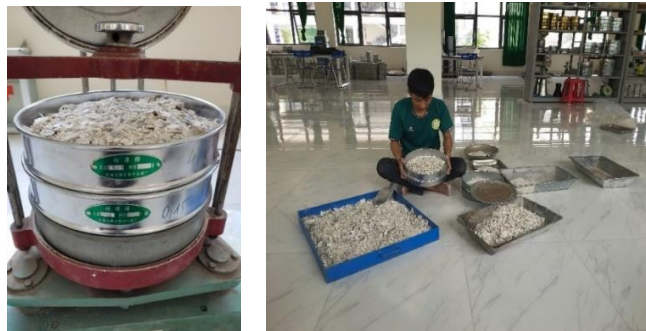
Hình 3.5. Sàng vỏ hào qua rây sàng #4.75mm và #0.15mm
