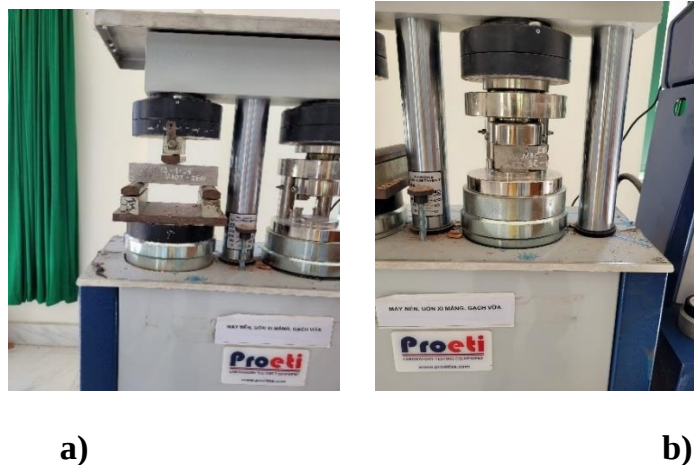
Hình 3.10. Kiểm tra tính chất cơ học: (a) uốn mẫu, (b) cường độ nén
