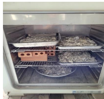
Hình 3.2. Sấy vỏ hàu bằng tủ sấy
